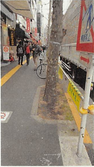
No.21 太根切断の可能性大、 掘取穴確保困難、埋設管障害
