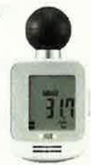
暑さ指数観測機器 (簡易型: 60mm × 112mm)
