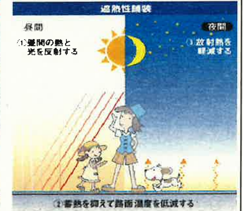
遮熱性舗装モデル図
